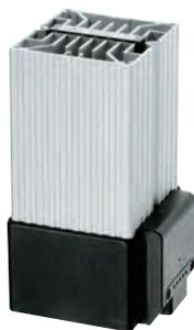
**Описание:** Обогреватель со встроенным вентилятором, может устанавливаться в желаемом положении, но предпочтительнее в вертикальном. Обеспечивает быстрый теплообмен. Эффективно препятствует образованию конденсата в шкафах. Быстрая установка на 35 мм DIN-рейку EN50022. Макс. температура поверхности 70°C (EGL250) и 85°C (EGL400).
