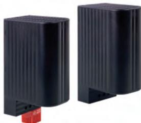
**Описание:** Вертикальный обогреватель с двойной изоляцией. С зажимом для 35 мм DIN-рейки в соответствии с EN60715. С защитой от прикосновения. Обогреватель имеет встроенный термостат (ЕСНТ), дополнительная разводка кабеля не требуется. Начальная температура 5°C, температура отключения 15°C.
