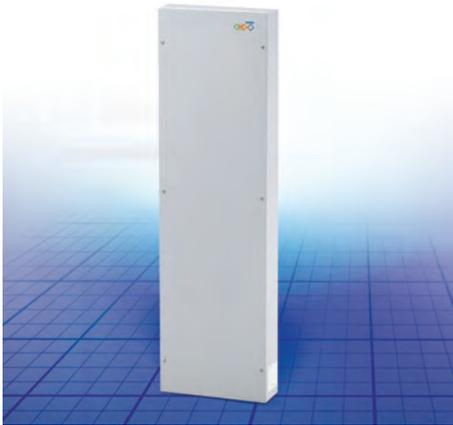
**Описание:** Для вертикальной установки. Герметизирован по краям. Дополнительных работ над внешними прорезями под теплообменник не требуется. Температура регулируется встроенным термостатом (от 8°C до 50°C, заводская установка 35°C) и соленоидным клапаном (дополнительно). Рабочее давление 10 бар. Производительность при W10/L35 и 200 л/час. Пожалуйста, используйте график для нахождения производительности под Вашими специфическими условиями.
