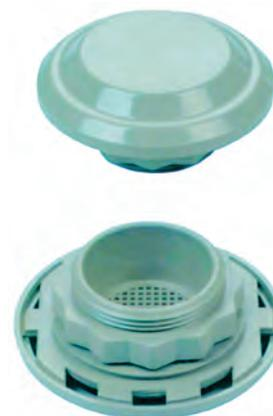
**Описание:** Для оптимального уравнивания давления. В распределительном шкафу может измениться давление, если произойдет значительное изменение температуры. В таком случае возникает опасность проникновения пыли или влажности в распределительный шкаф. Монтаж: резьбовое отверстие PG 29 с гайкой. Для оптимального уравнивания давления в шкафах рекомендуется использовать 2 заглушки, установленные по диагонали относительно друг друга. Уплотнительная прокладка NBR.
