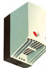
**Описание:** Эффективное предотвращение выделения конденсата в шкафах. Вентилятор поддерживает естественную конвекцию для лучшего распределения тепла. С двойной изоляцией. Защелкивается на 35 мм DIN-рейку (EN60715). Тепловое реле для аварийного отключения в целях предотвращения перегрева при отказе вентилятора. Контрольная лампочка термостата.
