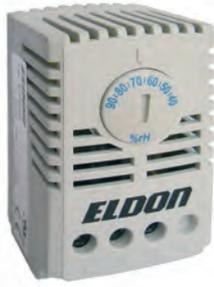
**Описание:** Механический гигростат, с контролем нагревания, если требуется стабильное и определенное значение влажности воздуха. Значение относительной влажности воздуха должно находиться выше значения "точки росы" - значение конденсата, чтобы избежать проникновения в шкаф конденсата и коррозии. Защищается на 35 мм DIN-рейку (EN 60715)
