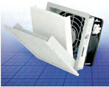
**Описание:** Фильтрующие вентиляторы Eldon и выходные фильтры с монтажной системой, не требующей винтов, и сокращающей время монтажа. Передняя крышка может быть открыта для быстрой и простой замены и обслуживания. Направление потока и положение подключения могут быть легко изменены. Эффективность фильтрации 91%. Подшипник скольжения и подшипник качения для DC вентиляторов и EF250R5 и выше. Новый фильтрующий материал повышает проток воздуха, а новая конструкция увеличивает срок службы.
