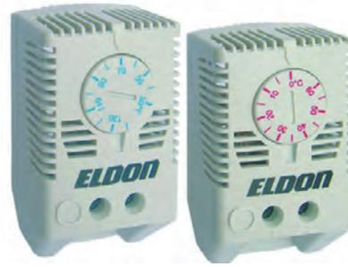
**Описание:** Термостат с переключающим контактом (НЗ/НР - заводская установка откр./закр.) для контроля температуры. ETR202 с заводской установкой НЗ (красный) для регулирования обогревателей. ETR201 с заводской установкой НР для регулирования холодильных агрегатов или сигнализаций. Термостатический сенсорный элемент из биметалла. Зажим для установки на 35 мм DIN-рейку (EN 60715).
