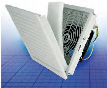
**Описание:** Фильтрующие вентиляторы и выходные фильтры установлены с помощью безвинтовой системы, сокращающей время установки. Передняя крышка может быть открыта для быстрой и простой замены и обслуживания. Направление потока и положение подключения могут быть легко изменены. Эффективность фильтрации 88% (91% для EF500R5 и выше). Подшипник скольжения, и подшипники качения для DC-версий и EF250R5.
