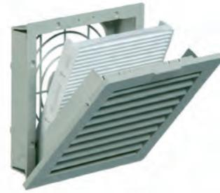
**Описание:** Фильтр, использующийся для натуральной вентиляции или в паре с фильтрующим вентилятором EFP. Удобный монтаж без винтов. Фронтальная крышка на петлях легко открывается для смены фильтрующей прокладки. Эффективность фильтрации 91%. Новый фильтр, имеющий более длительный срок службы, за счет сниженного давления благодаря особой конструкции.
