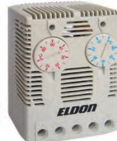
**Описание:** Два термостата в одном корпусе. Термостат (НЗ-контакт) для регулирования обогревателей. Термостат (НО-контакт) для регулирования фильтрующих вентиляторов, теплообменников или сигнализирующих устройств. Имеет биметаллический термостатический сенсорный элемент. Защелкивается при монтаже на 35 мм DIN-рейку, (EN 60715)
