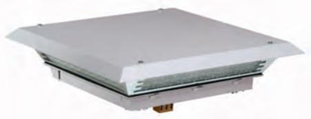
**Описание:** Вентиляторный блок для установки сверху шкафа, обеспечивает большой поток воздуха при низком уровне шума с помощью центробежного вентилятора. Блок легко устанавливается и необходимый вырез одинаков для блоков различной мощности. Эффективность фильтрации 81% для блоков с IP 54. Подшипник качения.
