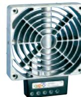
**Описание:** Высокопроизводительный, компактный обогреватель с вентилятором. Предотвращает образование конденсата и обеспечивает равномерное распределение температуры в шкафу. Зажим для 35 мм DIN-рейки EN50022. Терморегулируемая защита от перегрева в случае неисправности вентилятора, автоматический сброс.
