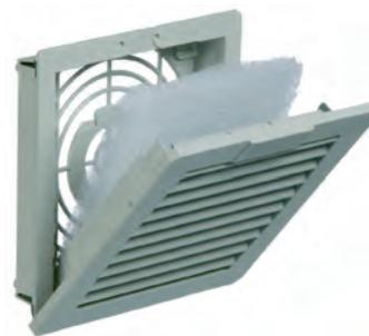
**Описание:** Выходной фильтр используется для естественной вентиляции или в паре с фильтрующим вентилятором EF. Инсталлируется без использования винтов. Фронтальная крышка на петлях может быть легко открыта для смены фильтрующей прокладки. Степень фильтрации 88% (91% для EFA500R5 и выше).
