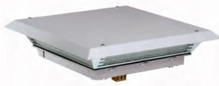
**Описание:** Вентиляционное устройство для установки сверху шкафа для обеспечения естественной вентиляции, т.е. без вентилятора. Устройство легко устанавливается, благодаря системе быстрой установки. Эффективность фильтрации составляет 81% для устройства IP54 (REU05R5).
