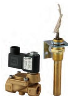
**Описание:** Соленоидный клапан и термостат для ограничения подачи сжатого воздуха. Срабатывает при условии необходимости охлаждения. Заводская установка термостата 35°C, возможна регулировка температуры. Управляемый термостатом вихревой охладитель рекомендуется, если тепловая нагрузка непостоянна и ли постоянный обдув не требуется.
