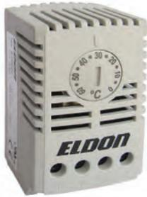
**Описание:** Термостат с перекидным контактом для регулирования температуры в шкафу. Сенсор из термостатического биметалла. Зажим на 35 мм DIN-рейку (EN 60715).
