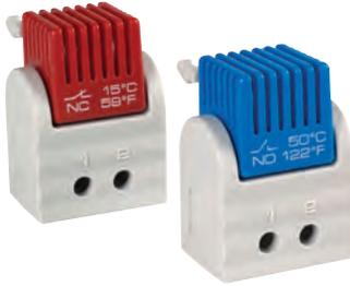
**Описание:** Термостат для регулировки температуры. Биметаллический чувствительный датчик. Красный (EFR202) НЗ - контакт для управления термостатом (НО-контакт, синий, EFR201) для управления устройствами климатизации или сигнальными устройствами. Зажим для установки на 35 мм DIN-рейку, EN50022.
